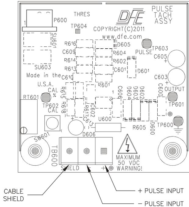
**Figure 33 - PULSE TACHOMETER CARD**
