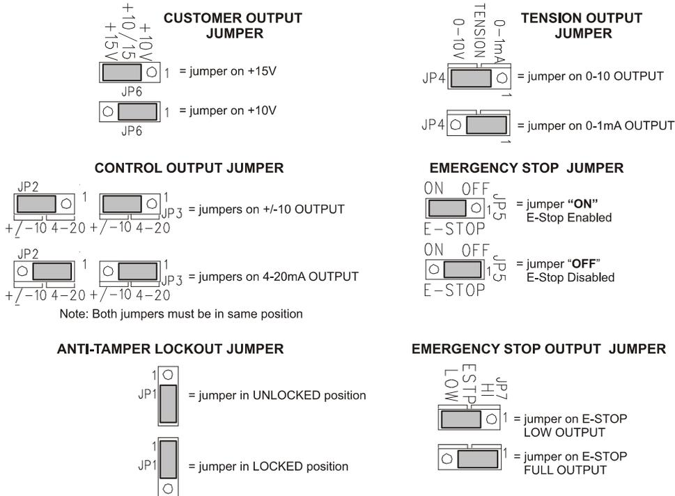
**Figure 47 - CONTROL BOARD SHOWING JUMPER LOCATIONS**
