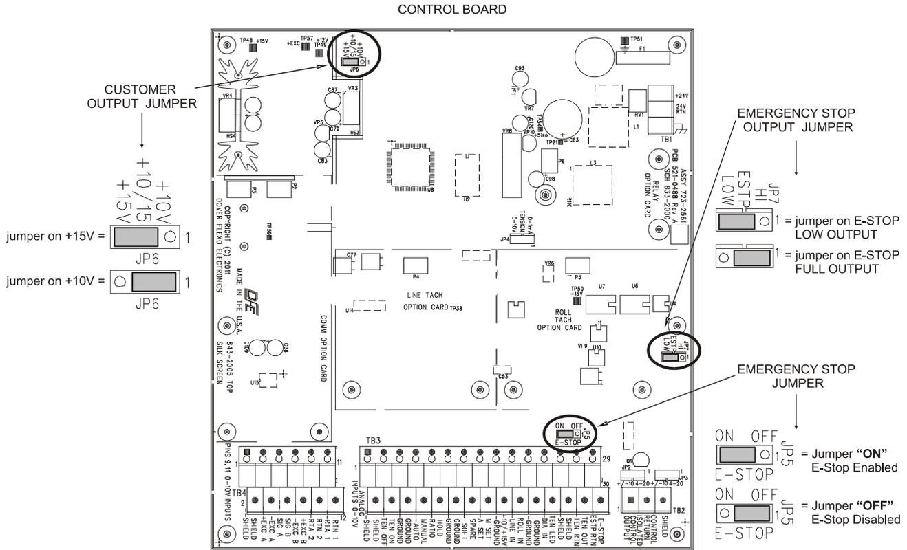
**Figure 9 – SETUP JUMPERS**
