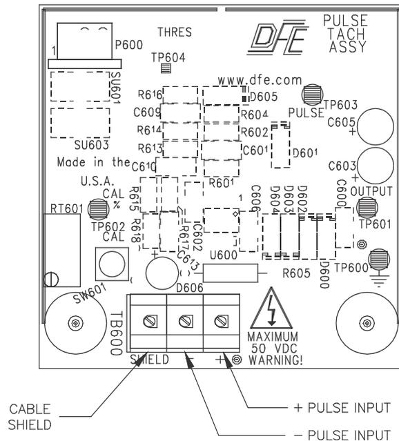
**Figure 37 - PULSE TACHOMETER CARD**
