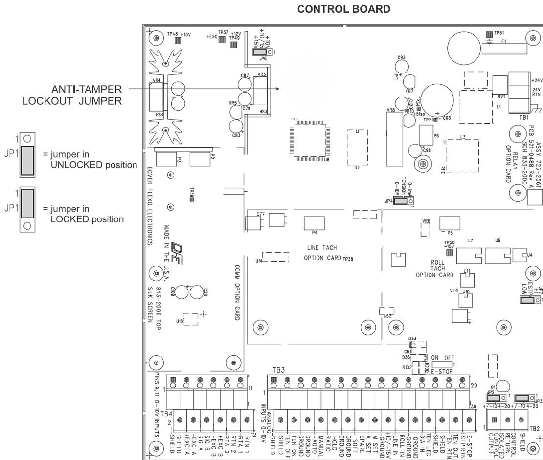
**Figure 38 – ANTI-TAMPER LOCKOUT JUMPER**
