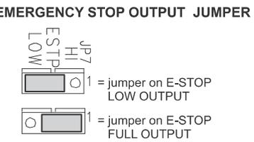
Figure 44 - CONTROL BOARD SHOWING JUMPER LOCATIONS
