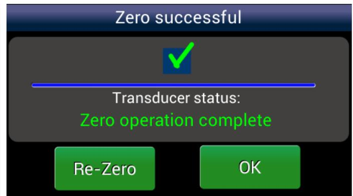
Figure 31 - ZERO OPERATION COMPLETE
