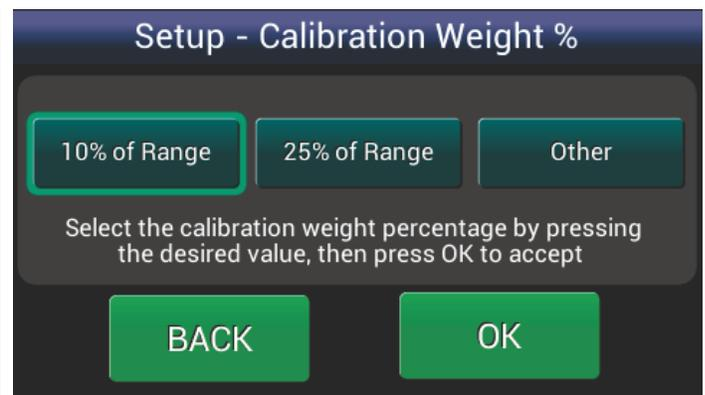
Figure 27 - SELECTION OF CALIBRATION WEIGHT
