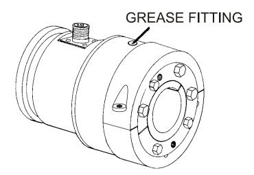
Figure 15 - GREASE FITTING LOCATION
