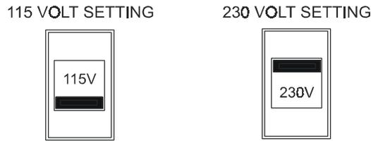
**Figure 14 - POWER SELECTION SWITCH SW201**
