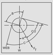
$$\frac{\text{NET}}{\text{FORCE}} = \frac{4\text{T SIN} \left(\frac{B}{2}\right) + \text{W COS(A)}}{2}$$
