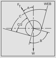
$$\frac{\text{NET}}{\text{FORCE}} = \frac{4\text{T SIN} \left(\frac{\text{B}}{2}\right) - \text{W COS(A)}}{2}$$
