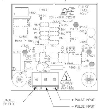
Figure 33 - PULSE TACHOMETER CARD
