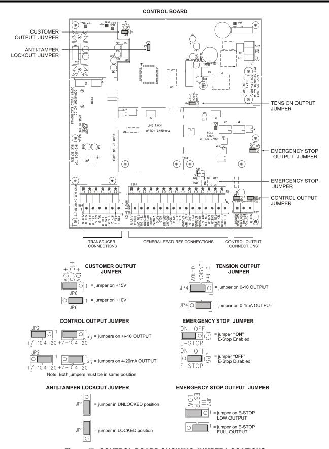
Figure 47 - CONTROL BOARD SHOWING JUMPER LOCATIONS
