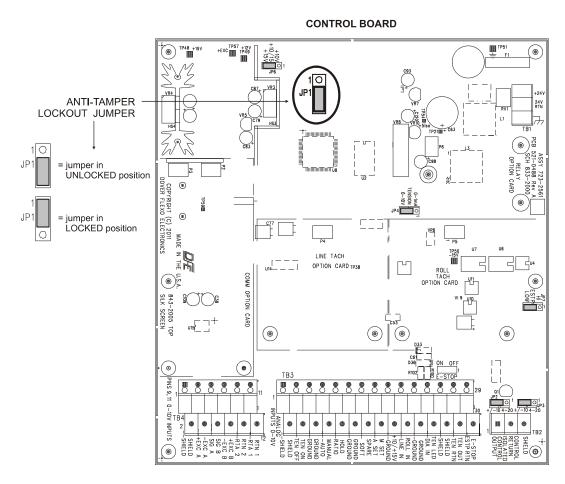
Figure 34 - ANTI-TAMPER LOCKOUT JUMPER
