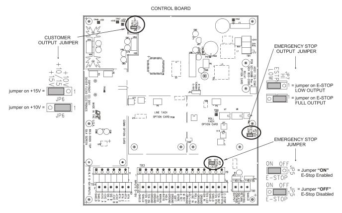
Figure 9 - SETUP JUMPERS
