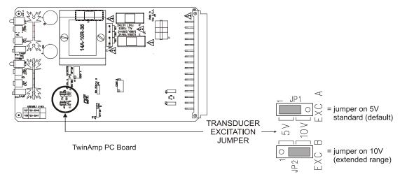
Figure 6 - TRANSDUCER VOLTAGE JUMPERS
