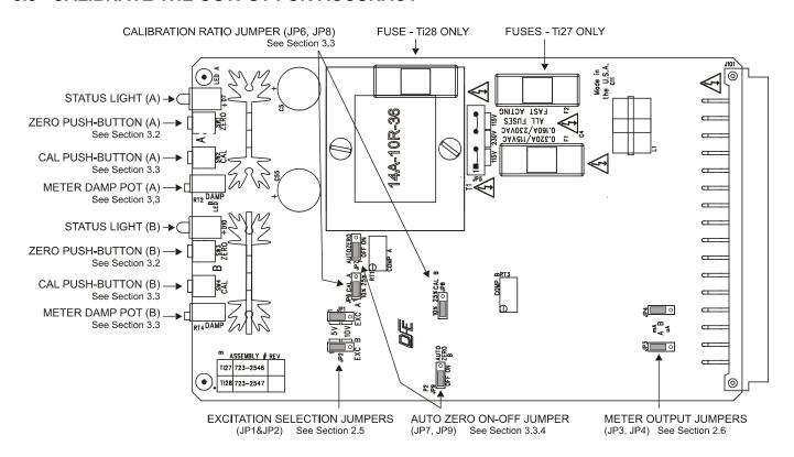
Figure 9 - TWINAMP SHOWING CAL, ZERO, and JUMPER LOCATIONS
